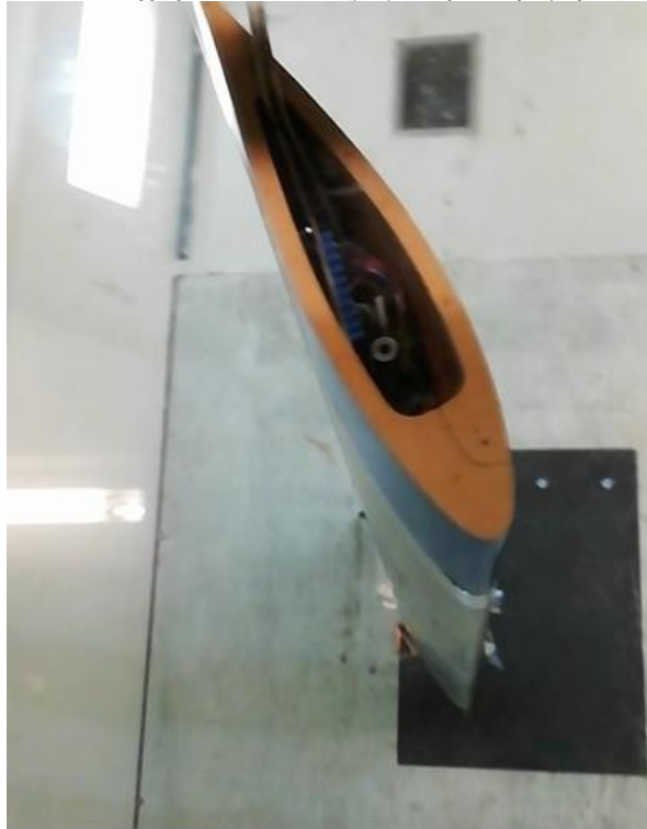
Σχ. 5 Η πτέρυγα με τις προεκτάσεις τοποθετημένη στην αεροδυναμική σήραγγα
