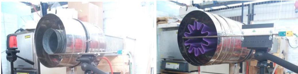
Σχήμα 3: Πειραματική διάταξη χωρίς (αριστερά) και με λοβωτό ακροφύσιο (δεξιά).
