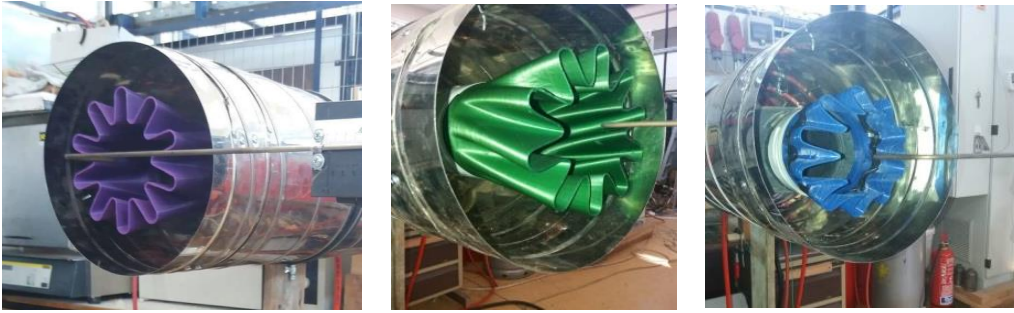
Σχήμα 5: Απλό ΛΑ - LNS (αριστερά), ΛΑ με συστροφή 16° (κέντρο) - LNT και αξονικό ΛΑ με όνυχες - LNN (δεξιά).
