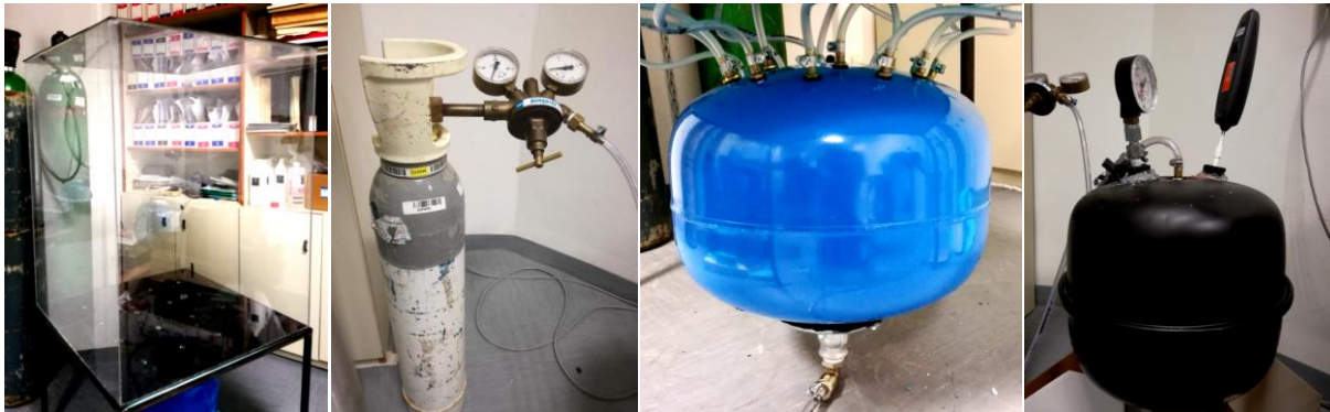
Σχήμα 1: Εξοπλισμός πειραματικής διάταξης: (α) κουτί plexiglass, (β) φιάλη CO 2 , (γ) δοχείο διαστολής 24 l, (δ) δοχείο διαστολής 12 l
