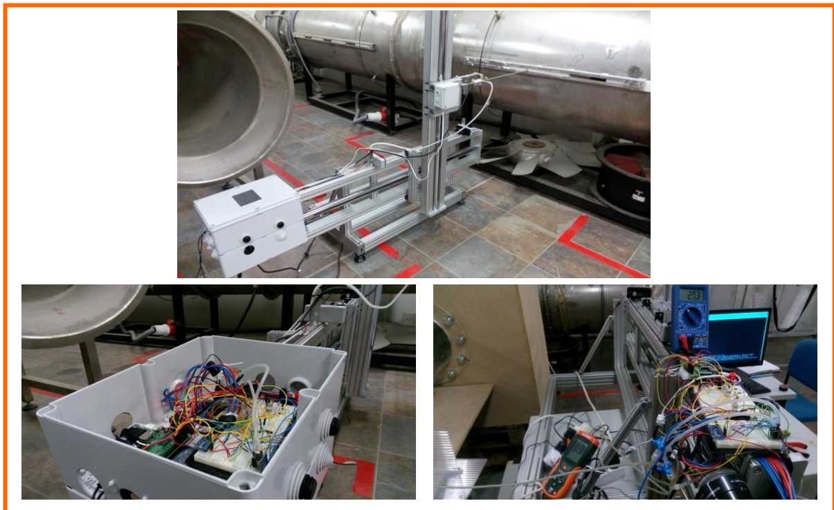
Εικόνα 7 Πειραματική διάταξη αεροσήραγγας
