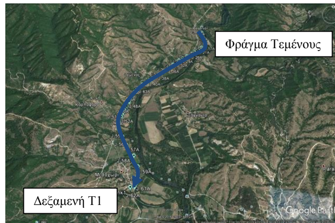
Σχήμα 3. Η τελική διαδρομή που ακολουθεί το πρώτο τμήμα του υδραγωγείου, από τον ταμιευτήρα στην δεξαμενή T1.
