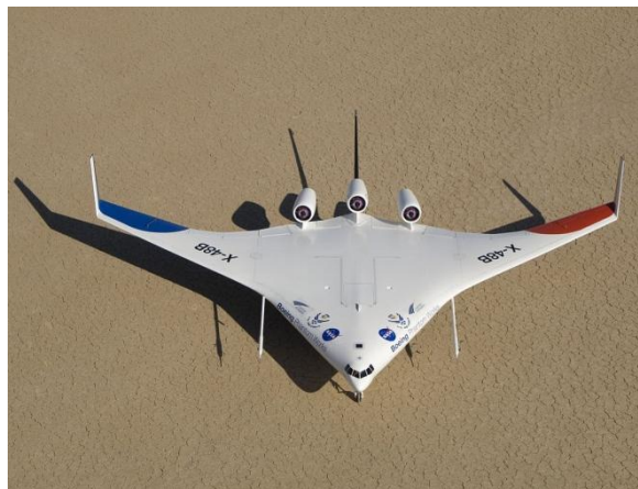
Εικόνα 1 Boeing X-48, το πρώτο κατασκευασμένο πρωτότυπο με γεωμετρία Blended Wing Body
